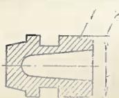
Деталь: поршень цилиндра привода выключения сцепления
