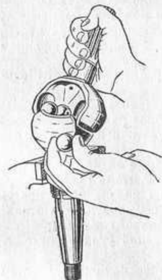
Рис. 83. Положение кулаков шарнира, в котором устанавливается последний шарик.
