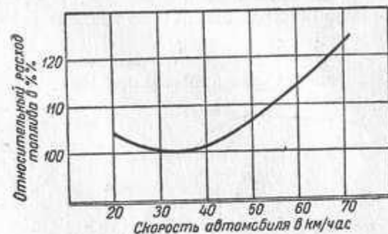
Рис. 125. График зависимости расхода топлива от скорости автомобиля (в процентах).
