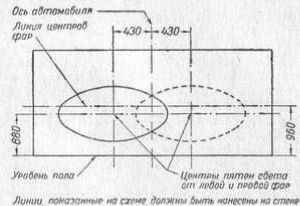
Рис. 67. Разметка экрана для регулировки фар.
