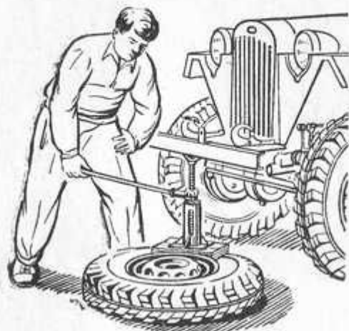
Рис. 116. Устранение прилипания покрышки.
